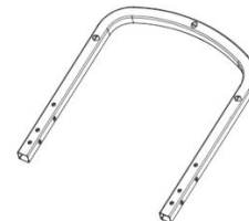
#17 Rückwärtiges Bodenstützrohr/ #17 Rear bottom support tube
